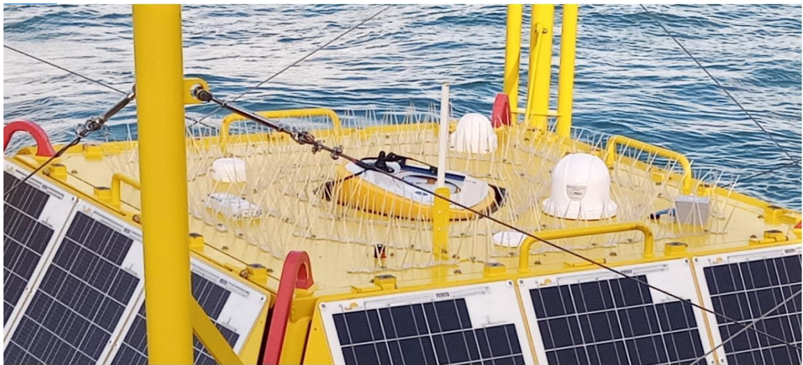
Figure 3.3: Espigões para dissuasão de aves na tampa superior da FLS200
