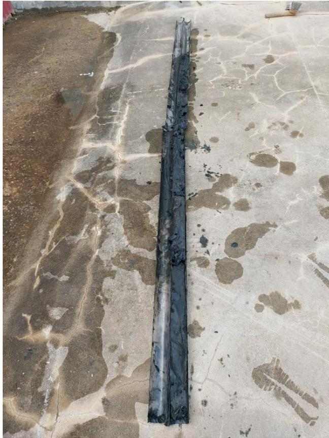
Fig.11 – Liners de PVC, contendo a amostra colhida verticalmente em VRST 2, com um comprimento de -2,5m. De notar que últimos 50cm do topo do liner superior estão vazios, pois o comprimento total dos liners era de 3 metros.
