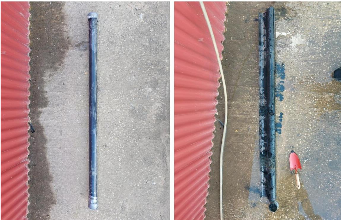
Fig. 12 e 13– Sedimentos colhidos no Ponto VRST 3. Na primeira imagem vê-se o liner de PVC cheio de sedimento, extraído do interior do amostrador, mas ainda rolhado na base e no topo, antes de ser aberto. Na segunda imagem, vê-se o liner já lavado exteriormente e aberto nas duas meias canas, permitindo o acesso ao sedimento colhido.
