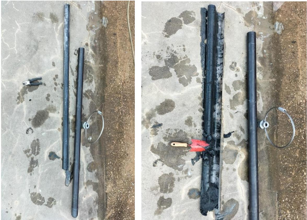
Fig. 8 e 9 – Sedimentos colhidos no Ponto VRST 1. Na primeira imagem vê-se o liner de PVC cheio de sedimento, extraído do interior do amostrador metálico que está ao lado, com o batente de topo. Na segunda imagem, o liner já foi aberto, em duas meias canas, permitindo acesso a todo o comprimento de sedimento amostrado.
