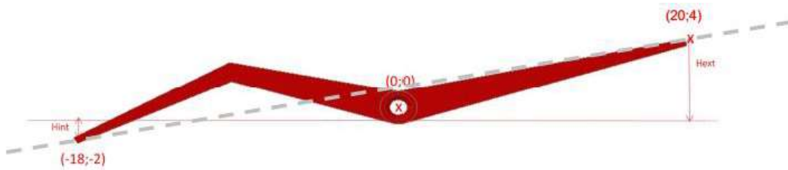
Figura 2-7. Esquema de rotação das alavancas.
